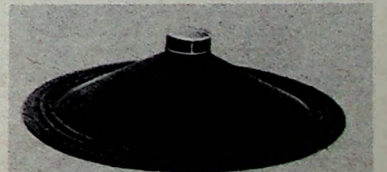
Bild 5. Membrane mit aufgeklebter Schwingspule
